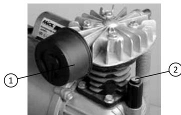
*Рис. 3. Установка воздушного фильтра*
