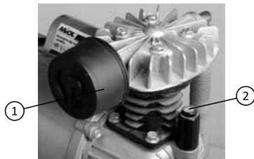
Мал. 3. Установка повітряного фільтра
